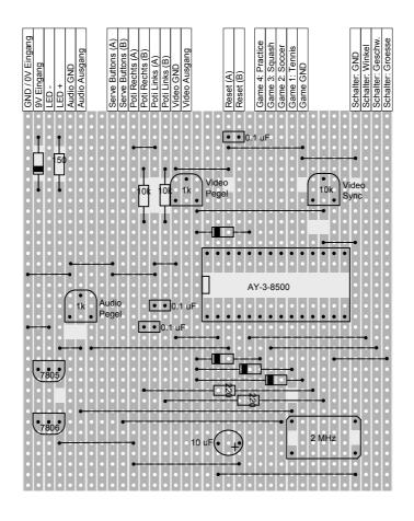
Gebaut wird das Ganze auf einer üblichen Lochstreifen-Platine. Die Zeichnung oben zeigt die Ansicht von der Bestückungsseite. Auf der Lötseite müssen vorher alle hellgrauen Flächen ausgebohrt werden, um Leiterbahnen zu unterbrechen.
